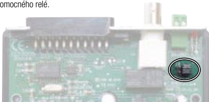
obr. 3: premiestnenie prepojok (12 V výstup alebo N. O. kontakt)
