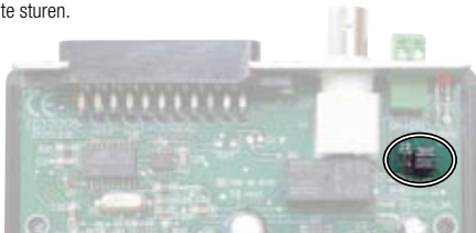
fig.3: jumpers verplaatsen (12V-uitgang of N.O.-contact)
