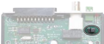
Zeichnung 3: Steckbrücken umstecken (12V-Ausgang oder Schließerkontakt)
