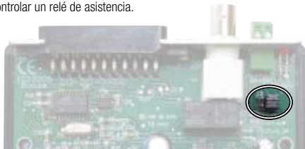
fig.3: desplazamiento de los elementos de unión (salida 12V o contacto N.A.)
