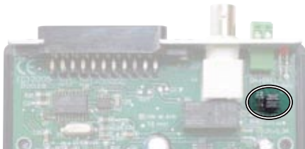
fig.3: déplacement des cavaliers (sortie 12V ou contact N.O.)
