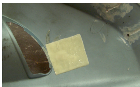
Reparación de una fisura en un spoiler
