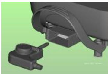
1. Lleve el controlador de temperatura a "OFF" y luego inserte el testeador de temperatura en le receptáculo. Luego coloque el enchufe en la toma.
