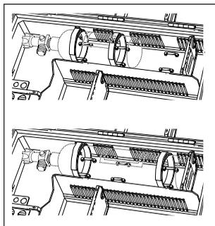
Para fijar botellas de oxígeno de los tamaños 0,8 l o 2,0 l en la parte inferior del maletín, se puede utilizar el accesorio "WM 15141 Set 2 correas tensoras para botella de oxígeno" **27**. Fije la botella de oxígeno en el compartimento para la botella de oxígeno según la figura. Utilice para la fijación de una botella de oxígeno de 2,0l los estribos exteriores en la base.
