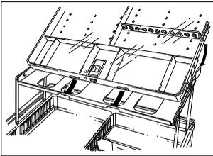
Para insertar el cajetín para ampollas, introduzca los salientes en las escotaduras de la chapa de alojamiento y apriete el cajetín hacia abajo hasta que los bloqueos laterales encajen en las chapas de resorte.
