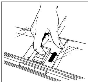
Para abrir la placa de recubrimiento, accione el cierre y abra la placa de recubrimiento hasta que el soporte encaje.
