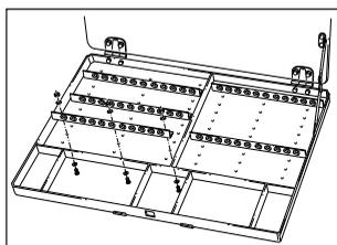
Las bandejas porta-ampollas del cajetín para ampollas se pueden desplazar. Para este fin, suelte los elementos de sujeción y fije las bandejas porta-ampollas en la posición deseada. También se pueden fijar en el punto deseado del cajetín para ampollas
