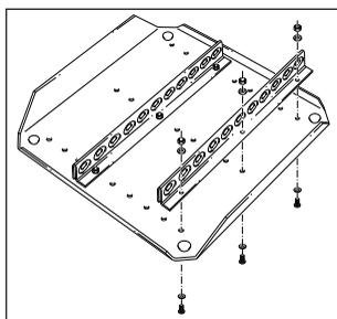
Las bandejas porta-ampollas se pueden desplazar en los paneles porta-ampollas. Para este fin, suelte los elementos de sujeción y fije la bandeja porta-ampollas en la posición deseada.
