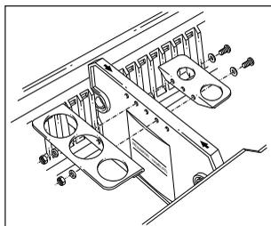
Los soportes para tubos están fijados de fábrica en el separador "Base mediano" **18**. Es posible desplazar el soporte para tubos hacia otro separador de la parte inferior del maletín. Para este fin, suelte los elementos de sujeción y fije el soporte para tubos en la posición deseada.
