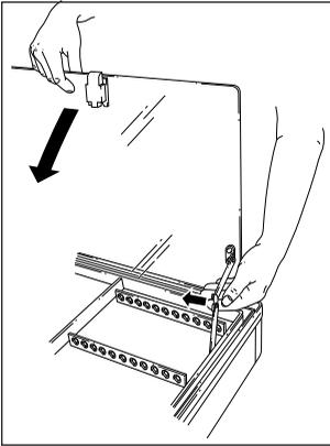
La placa de recubrimiento queda bloqueada una vez abierta. Para cerrar, pliegue el soporte y cierre la placa de recubrimiento hasta que encaje el cierre.
