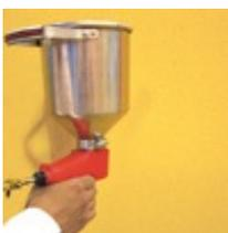
Proyectar en una sola mano, **weber.plast super iggam P granitex** con máquina tolva. Utilizar compresor a diafragma (continuo) o compresor de tanque de recuperación rápida con regulador de salida (35 lbs/pulg2)
