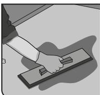
4. Aplicar el mortero en espesores no mayores a 15mm, en caso de ser necesario aplicar en 2 capas o utilizar Lanko Nivelador de Piso
