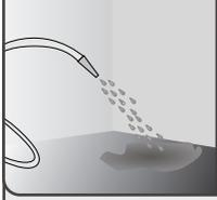
En climas calurosos, las superficies deberán saturarse con agua potable en forma pareja el día previo a la faena. Las palmetas jamás deben dejarse al sol. En soportes muy absorbentes se puede aplicar LANKO PRIMER 124 previa aplicación del adhesivo.
