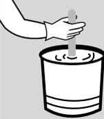
Amasar el adhesivo con la cantidad de agua indicada, en un recipiente limpio y estanco, nunca en el piso, use batea o carretilla. Si es posible, usar mezclador mecánico hasta obtener una mezcla homogénea y dócil. Si el amasado es manual se requiere agitar vigorosamente hasta obtener una pasta sin grumos.
