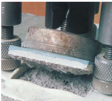
Máxima adherencia: rotura por el hormigón.
