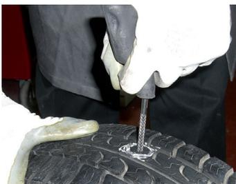
Extraer el objeto que ha pinchado el neumático e inflarlo a una presión de 1 bar. Introducir el punzón estriado por el orificio impregnado de cemento vulcanizante para que el neumático no se desinflen.
