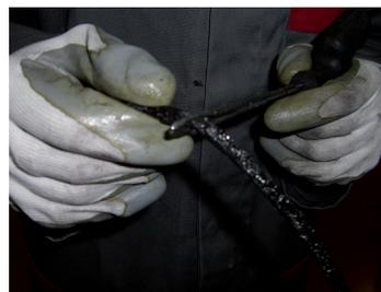
Introducir el obturador por la ranura del punzón de aplicación y aplicar una capa de cemento vulcanizante.
