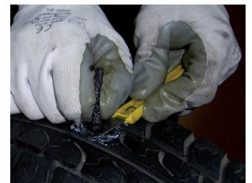
Extraer el punzón de aplicación, quedando parte del obturador dentro del neumático. Cortar el obturador a ras del neumático e inflar la rueda a la presión indicada por el fabricante.
