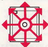
Você poderá controlar os movimentos do avião com a alavanca (controle manual da direita). Para a frente e o avião descera. Puxando para si o avião subirá. Etc.
