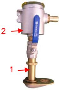
La llave debe estar colocada lo más abajo posible de la línea de flotación y accesible. Las aperturas del avispero deben estar colocadas hacia la proa del barco con el fin de facilitar la entrada del agua del mar por recogida durante la navegación. La fijación de la parte sumergida debe hacerse con Rubson o Sicaflex. La fijación de la llave paso y del avispero puede realizarse con Tubo Estanco 577 Loctite o Teflón.
