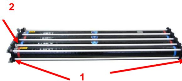
*Posdata:* Con el fin de facilitar la orientación de las conexiones de las abrazaderas inoxidables (2) es posible girar las cabezas 90°. Para ello, desenroscar los embudos grises de producción. Quitar a continuación los tapas tuercas y desenroscar las 12 tuercas manteniendo el conjunto. Quitar el tirante que moleste y gire la cabeza de la membrana con la ayuda de una llave de tubo encajada en el embudo inoxidable. Sustituir el tirante y roscar de nuevo el conjunto.
