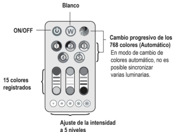
La distancia de trabajo del mando a distancia hasta la unidad de iluminación es de entre 3 y 5 metros, dependiendo del entorno de la instalación.
