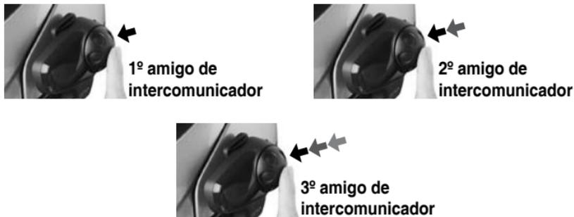
2. Para finalizar una conversación a través del intercomunicador, pulse una vez mando giratorio de selección. Podrá finalizar cualquier conexión que mantenga con cualquier amigo de intercomunicador pulsando una sola vez dicho botón. En este caso, una pulsación doble o triple no tendrá ningún efecto.
