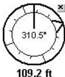
La línea vertical en la parte superior de la brújula representa la dirección de desplazamiento. La flecha que se mueve representa la dirección deseada. La distancia al objetivo se muestra debajo de la brújula.
