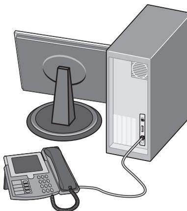
**5** Conecte un tercer cable telefónico del módem del ordenador al puerto EXT
