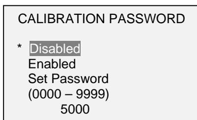
Para establecer la contraseña, seleccione **Enabled (Habilitada)** y, a continuación, **Set Password (Establecer contraseña)**. Utilice las teclas **ARRIBA** y **ABAJO** para incrementar y disminuir el valor, de 0 a 9999. Cuando haya seleccionado el valor deseado, presione **ENTER** y, a continuación, **ESC** para salir del submenú.
