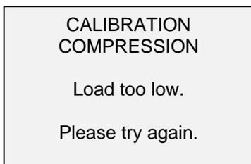
El peso de calibración no coincide con el valor ajustado.
