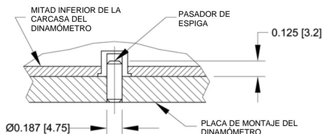
3.1.3 Montaje de las fijaciones al dinamómetro
