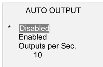
Seleccione **Enabled (Habilitada)** para activar la salida automática. El número de salidas por segundo se puede ajustar a 1, 2, 5, 10, 25, 50, 125 ó 250. Al seleccionar la velocidad de salida de datos debe tenerse en cuenta la capacidad del dispositivo receptor.
