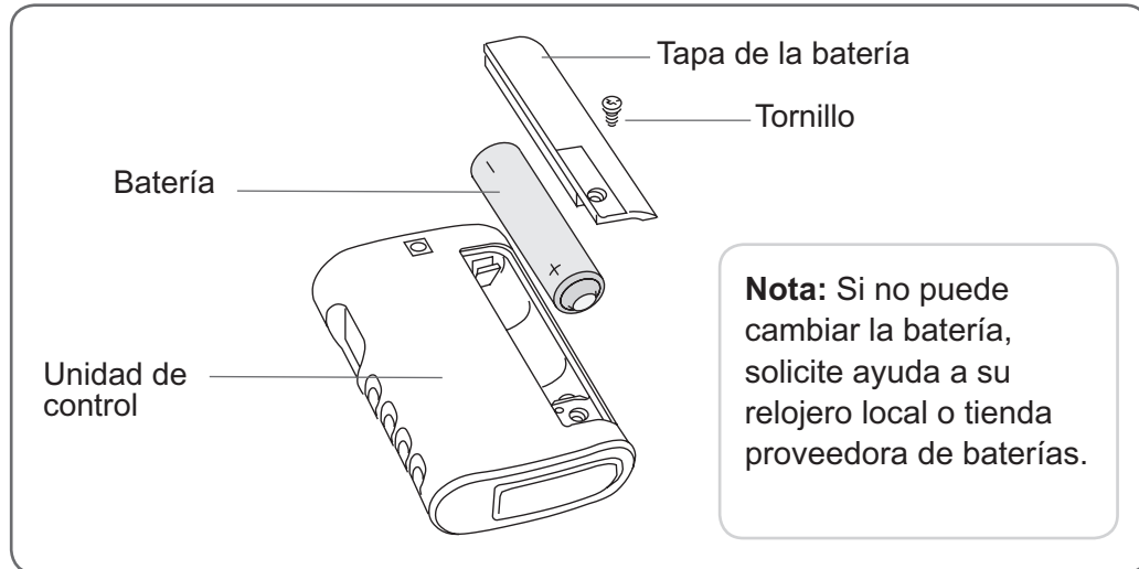
Figura 18: Cómo sustituir la batería de la unidad de control.
