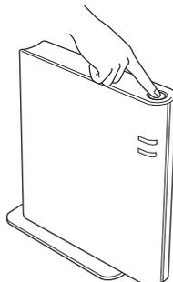
**6** Espere hasta que el testigo **Ready** de la máquina indique Conectado. El testigo **Ready** se encenderá durante 5 minutos. (Vea la siguiente tabla) Esta indicación significa que la máquina ha conectado correctamente con el punto de acceso o enrutador de WLAN. A partir de este momento podrá utilizar su máquina en una red inalámbrica.
