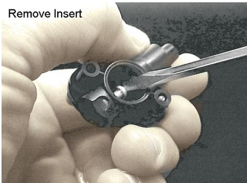
3. Cuando sea necesario, limpiar la parte superior de la pieza de inserción y el interior del impactador, para eliminar las partículas acumuladas.
