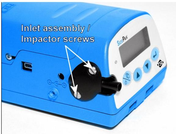
2. Use un destornillador pequeño para empujar contra el reborde en el vástago de inserción y deslice la tapa para extraerla del impactador.
