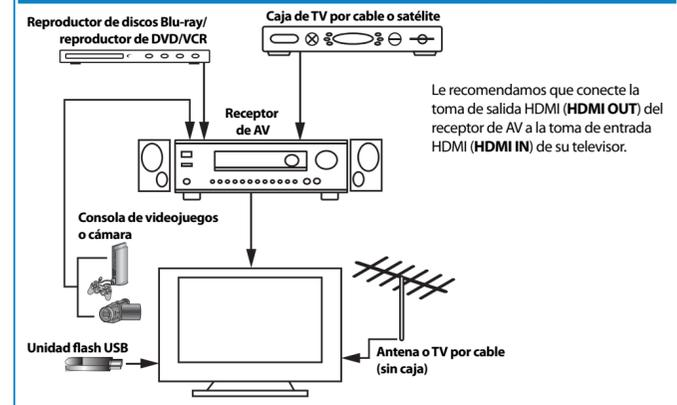
Le recomendamos que conecte la toma de salida HDMI (HDMI OUT) del receptor de AV a la toma de entrada HDMI (HDMI IN) de su televisor.
