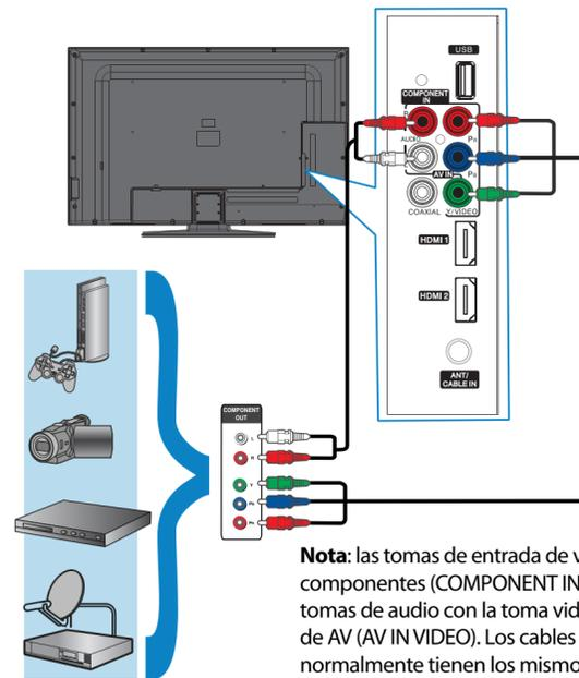
**Nota:** las tomas de entrada de video de componentes (COMPONENT IN) comparten las tomas de audio con la toma video de entrada de AV (AV IN VIDEO). Los cables y las tomas normalmente tienen los mismos colores.
