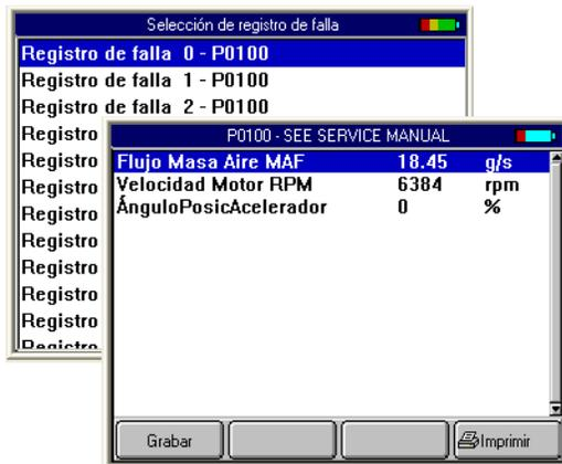
Figura 7.20: Pantalla Registros de Falla y Pantalla de Datos DTC
