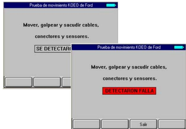
Figura 7.19: Pantalla Prueba de Movimiento de Cables
