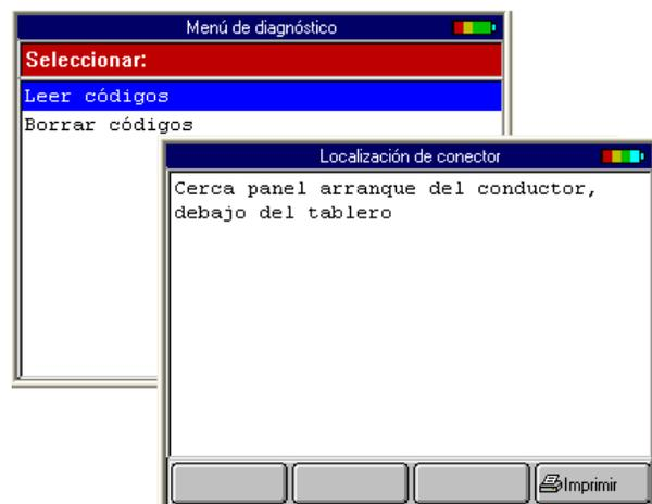
Figura 7.24: Pantallas Menú de Diagnostico y Localización de Conector
