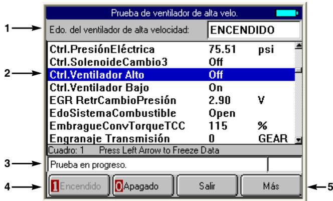
Figura 13.4: Ejemplo de Pantalla de Control de Componente Múltiple
