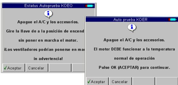
Figura 7.12: Pantalla Instrucciones Autoprueba KOEO y KOER
