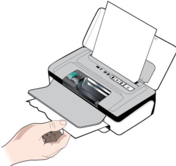
7. Si el soporte atascado no está a la vista en la zona de impresión ubicada al interior de la impresora, extraiga lo que sea visible en la bandeja de entrada.
