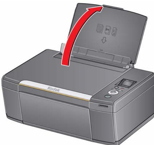
2. Abra la bandeja de salida, luego tire del alargador hasta que quede completamente extendido.
