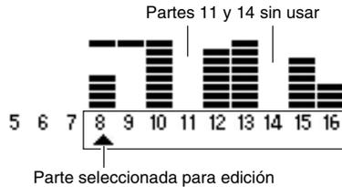
Mientras se reproduce la secuencia, los **botones (1 a 16) 4** se iluminan y apagan continuamente, indicando el movimiento de las notas de la parte que se está editando (la parte indicada por el puntero (▲) en la ilustración de arriba. Así es como el secuenciador por pasos produce repetidamente los 16 pasos.
