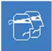
Este icono puede tener dos posiciones: parpadeante (durante el tiempo de activación del sistema de intrusión) o fijo (si el sistema de intrusión está activado). Permite desactivar el sistema de intrusión (a través código pin).
