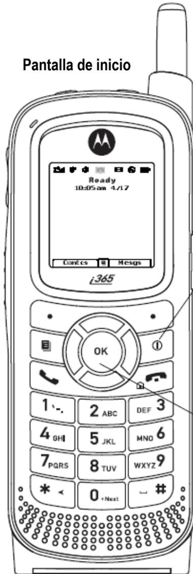
① Oprima y mantenga oprimida la **tecla de encendido**
