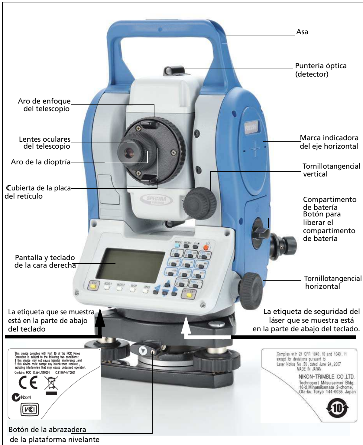
Figura 3.1 Vista posterior de la estación total Focus 6 de 5" (Cara derecha)
