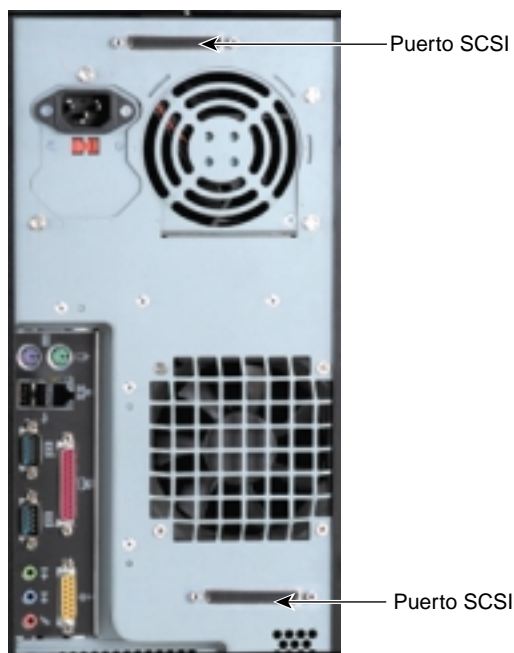
Figura 1-5 Puertos SCSI en la parte posterior de la unidad base
