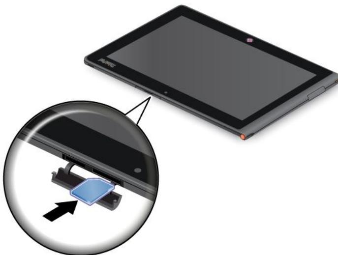
4. Cierra la cubierta de la ranura de tarjeta SIM y reinicie el tablero.
