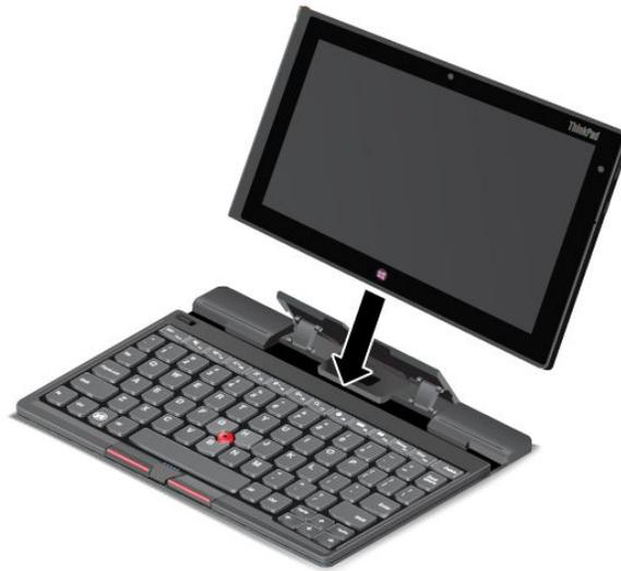
Figura 8. Instalación del tablero en el teclado Bluetooth
