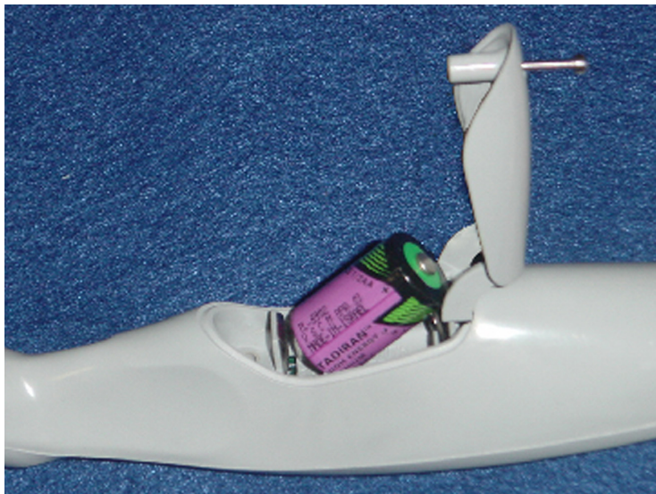
Figura 3 Instalación de la pila
