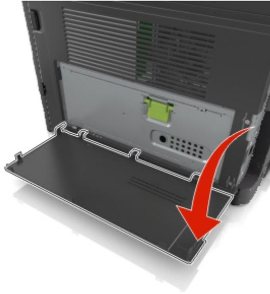
2. Abra la protección de la placa de la controladora utilizando la palanca verde.
