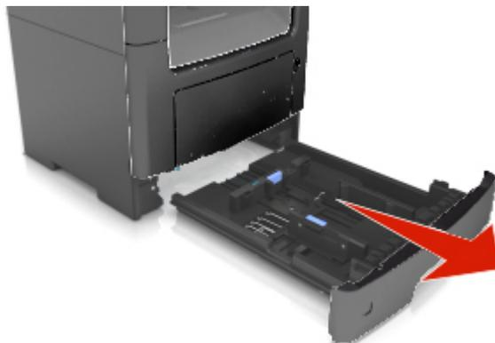
2. Presione y deslice la lengüeta de la guía de anchura hasta colocarla en la posición correcta para el tamaño de papel que esté cargando.
