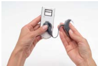
Figura 82: colocar la bobina en las guías del sensor de la bobina
