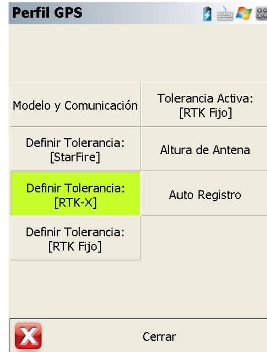
*Imagen 30: Perfil de GPS/Parámetro de tolerancia [RTK-X]*
