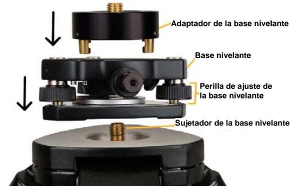
*Imagen 16: Armado de la base nivelante y del adaptador de la base nivelante*
