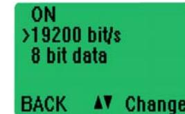
*Imagen 50: Configuración de la tasa de baudios*
