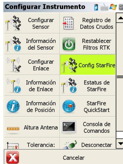
*Imagen 26: Configuraciones del instrumento/Satélite alternativo de StarFire*
