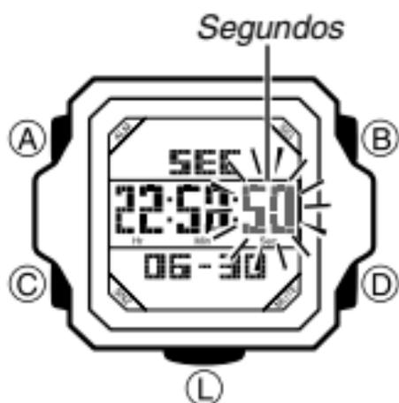
1. En el modo de hora normal, mantenga presionado (A) hasta que los segundos comiencen a parpadear, indicando que está en la pantalla de ajuste.
