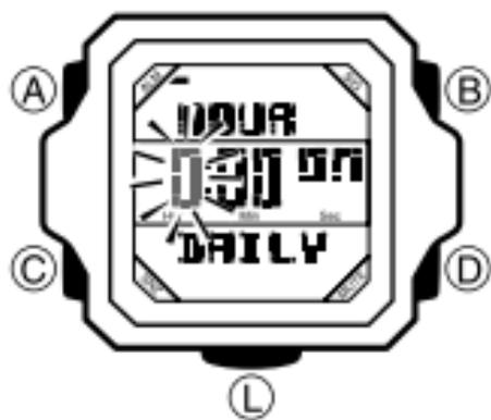
1. En el modo de alarma, utilice (D) para desplazarse a través de las pantallas de alarma hasta que aparezca la pantalla cuyos ajustes desea configurar.
