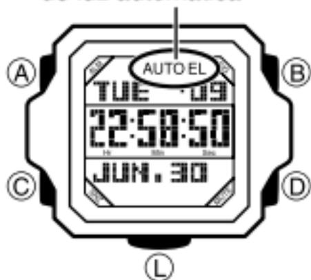
Este reloj cuenta con un panel EL (electroluminiscente) que ilumina toda la presentación para facilitar la lectura en la oscuridad. El interruptor de luz automática del reloj enciende automáticamente la iluminación cuando usted inclina el reloj hacia su cara.
