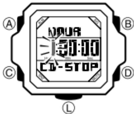
Utilice (D) (+) y (B) (-) para cambiar el ajuste que está destellando.
