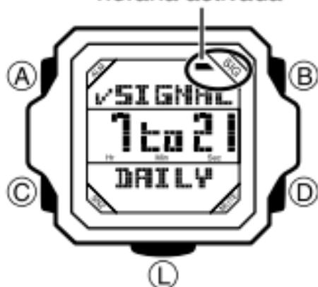
1. En el modo de alarma, utilice (D) para visualizar la pantalla de señal horaria (**SIGNAL**).
