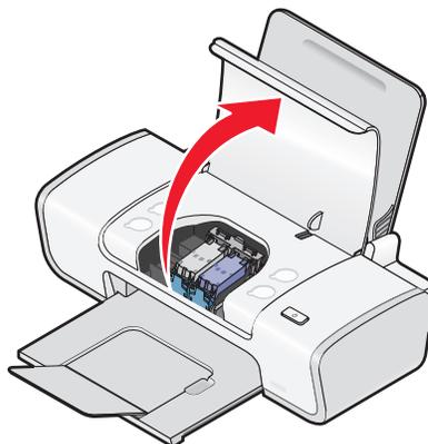
**3** Presione hacia abajo la palanca del carro del cartucho para levantar la tapa.
