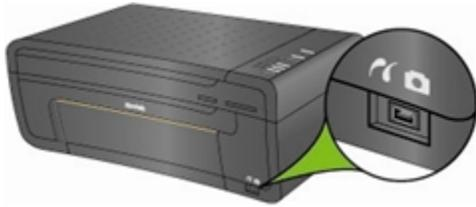
Puede utilizar el puerto USB del panel frontal de la impresora multifunción Kodak ESP 3 para conectar una cámara PictBridge e imprimir imágenes directamente desde la cámara. La impresora multifunción Kodak ESP 3 puede acceder a las imágenes de la mayoría de cámaras digitales.
