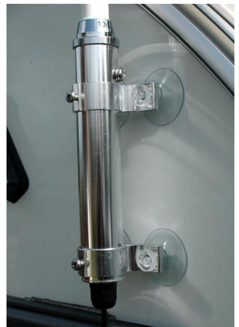
Después de haberse asegurado que la superficie del GRP donde desee montar la antena WL50 está limpia, humedezca ligeramente cada ventosa y a continuación empuje la antena con cuidado hasta que las ventosas queden planas.
