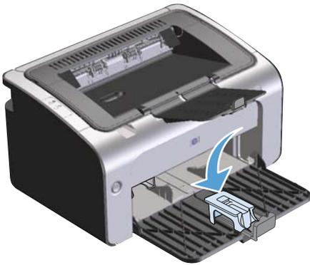
3. Inserte el sustrato en el producto hasta que se detenga y luego deslice la guía ajustable de sustratos, con el extensor incluido para soportar el sustrato.
