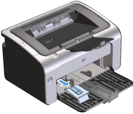
2. Acople la herramienta a la guía ajustable para medios de impresión.
