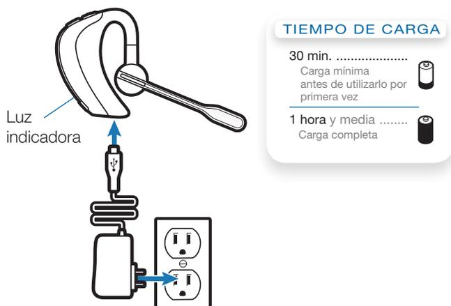
**NOTA** Efectúe siempre la carga a una temperatura cercana a la temperatura ambiente. No cargue nunca la batería a temperaturas inferiores a 0°C (32°F) o superiores a 40°C (104°F).
