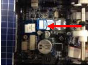
d) Deslice la tarjeta de memoria en la ranura para tarjetas vacía y bloquee el pestillo
