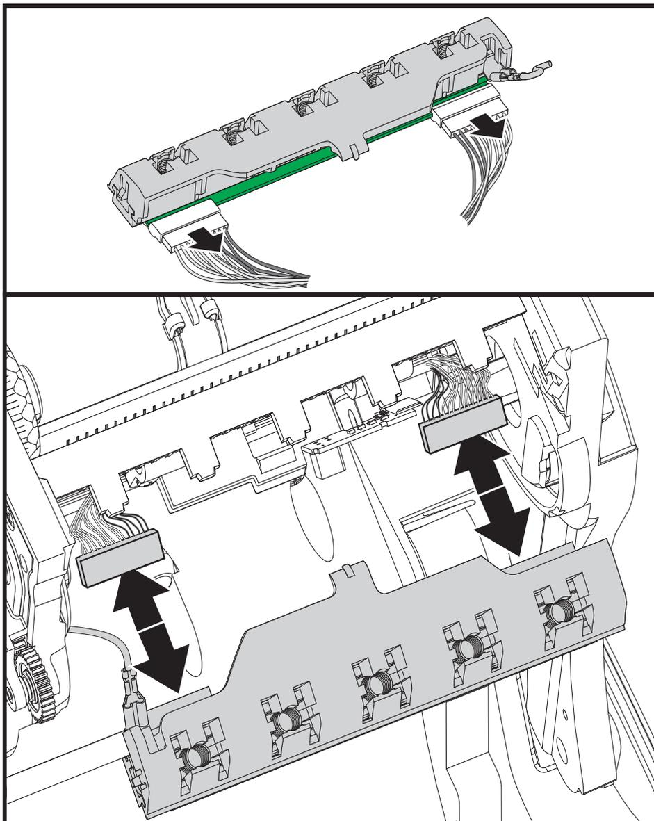
5. Extraiga con cuidado y firmeza el conductor de tierra de color verde del cabezal de impresión.
