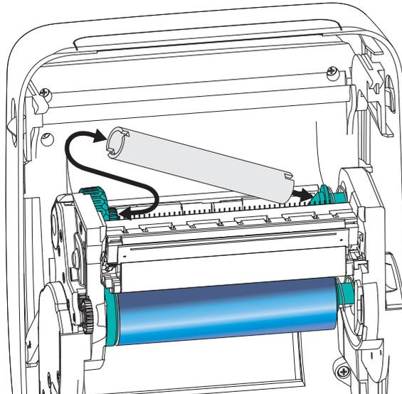
Puede encontrar su primer tubo de tensado de la cinta en la caja de embalaje. Posteriormente, utilice el tubo de suministro vacío para tensar el siguiente rollo de cinta.
