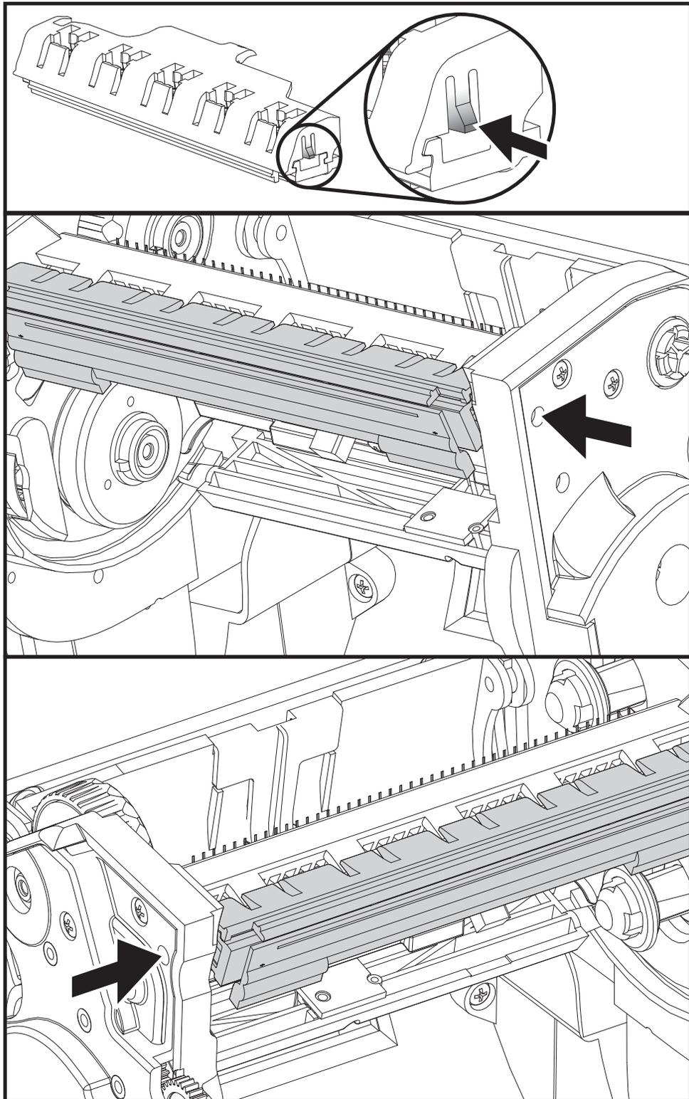
4. Extraiga con cuidado y firmeza los dos conectores de haces de conductores del cabezal de impresión.
