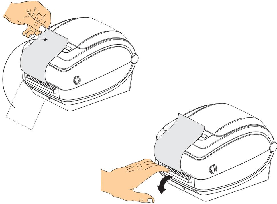
3. Inserte el papel protector de la etiqueta entre la puerta del distribuidor y el cuerpo de la impresora.
