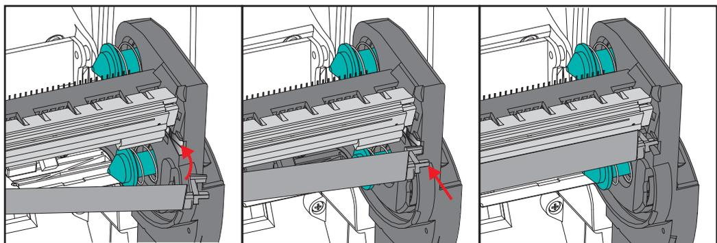
7. Verifique que el cabezal de impresión se mueva hacia arriba y hacia abajo libremente cuando se aplica presión y se trabe cuando se suelta.
