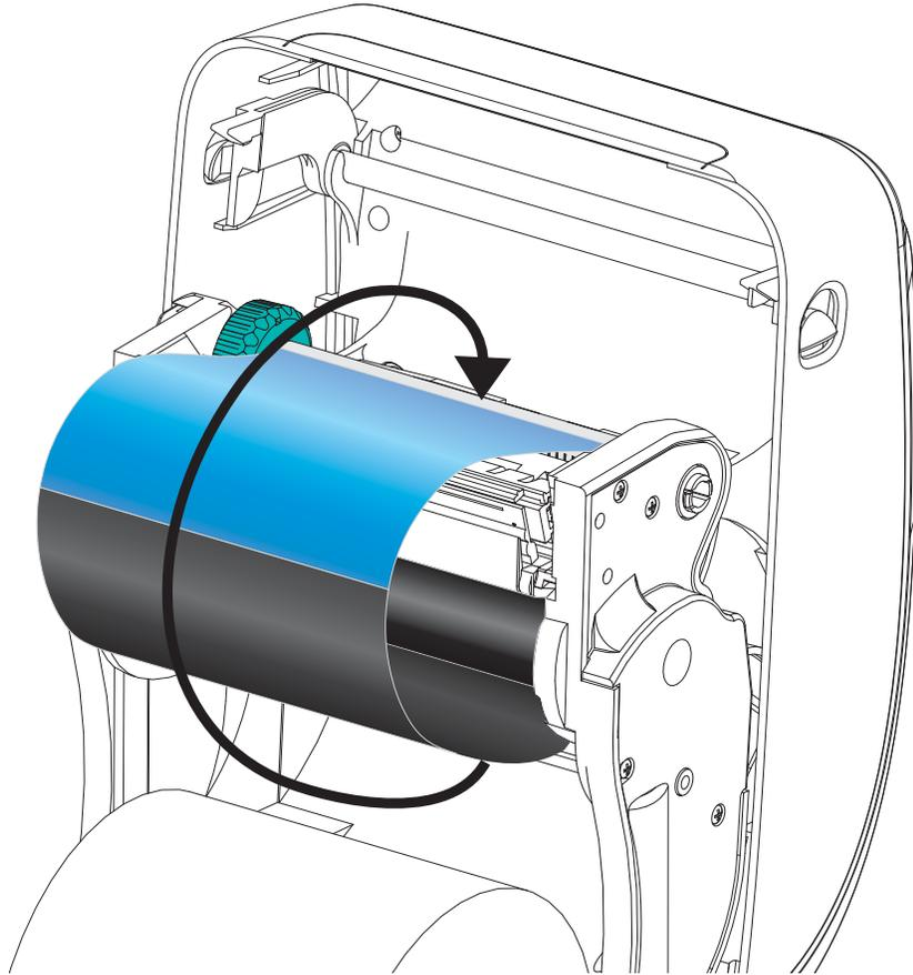
4. Gire la rueda de control del lado izquierdo del rodillo de suministro hasta que la cinta quede ajustada en el cabezal de impresión.
