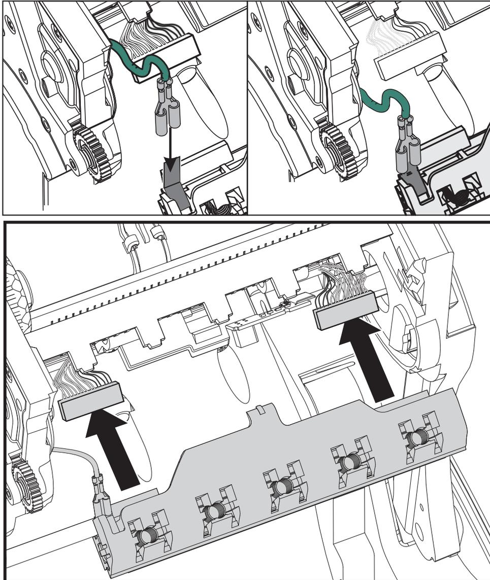
5. Inserte la lengüeta del soporte del cabezal de impresión en la ranura del conjunto del bastidor de la cinta. Alinee las ranuras del resorte del cabezal de impresión con los cinco montantes e inserte el cabezal de impresión en el bastidor de la cinta.
