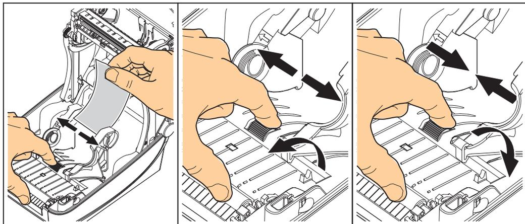
3. Inserte el papel a través de la ranura en la parte posterior de la impresora.
