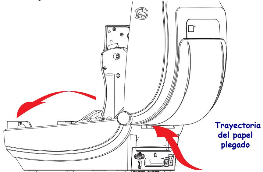
2. Ajuste la posición de detención de la guía del papel con la rueda de control verde. Utilice un trozo de papel plegado para ajustar la posición de detención. Gire la rueda hacia usted para que la apertura de las guías sea más amplia. Gire la rueda alejándose de usted para que la apertura de las guías de papel sea más angosta.
