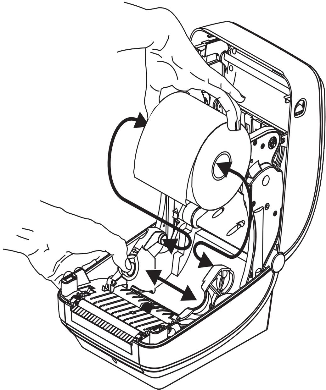
3. Tire del papel de manera que se extienda fuera del frente de la impresora. Verifique que el rollo gire libremente. El rollo no debe apoyarse en la parte inferior del compartimiento del papel. Verifique que la superficie de impresión del papel esté hacia arriba.
