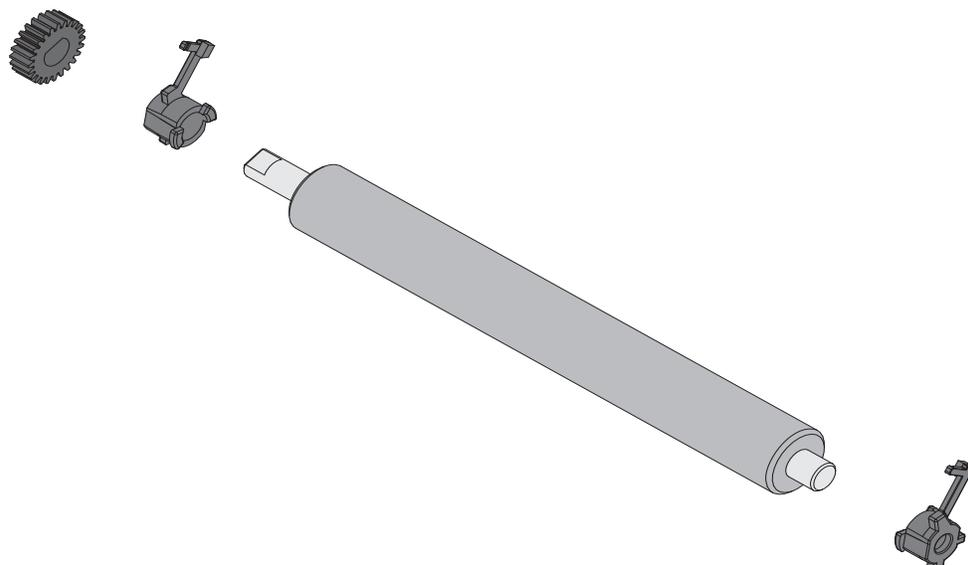
7. Alinee el rodillo portapapeles con el engranaje a la izquierda y bájelo dentro del bastidor inferior de la impresora.
