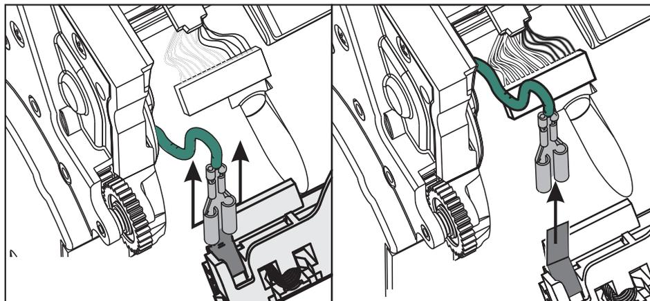
**Reemplazo del cabezal de impresión**
