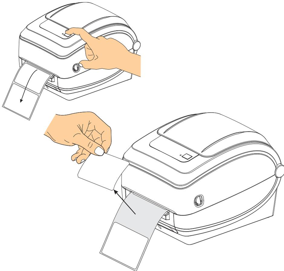
2. Levante el papel protector por encima de la parte superior de la impresora y abra la puerta del distribuidor.
