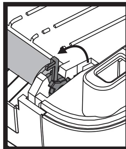
3. Levante el rodillo portapapeles fuera del bastidor inferior de la impresora.
