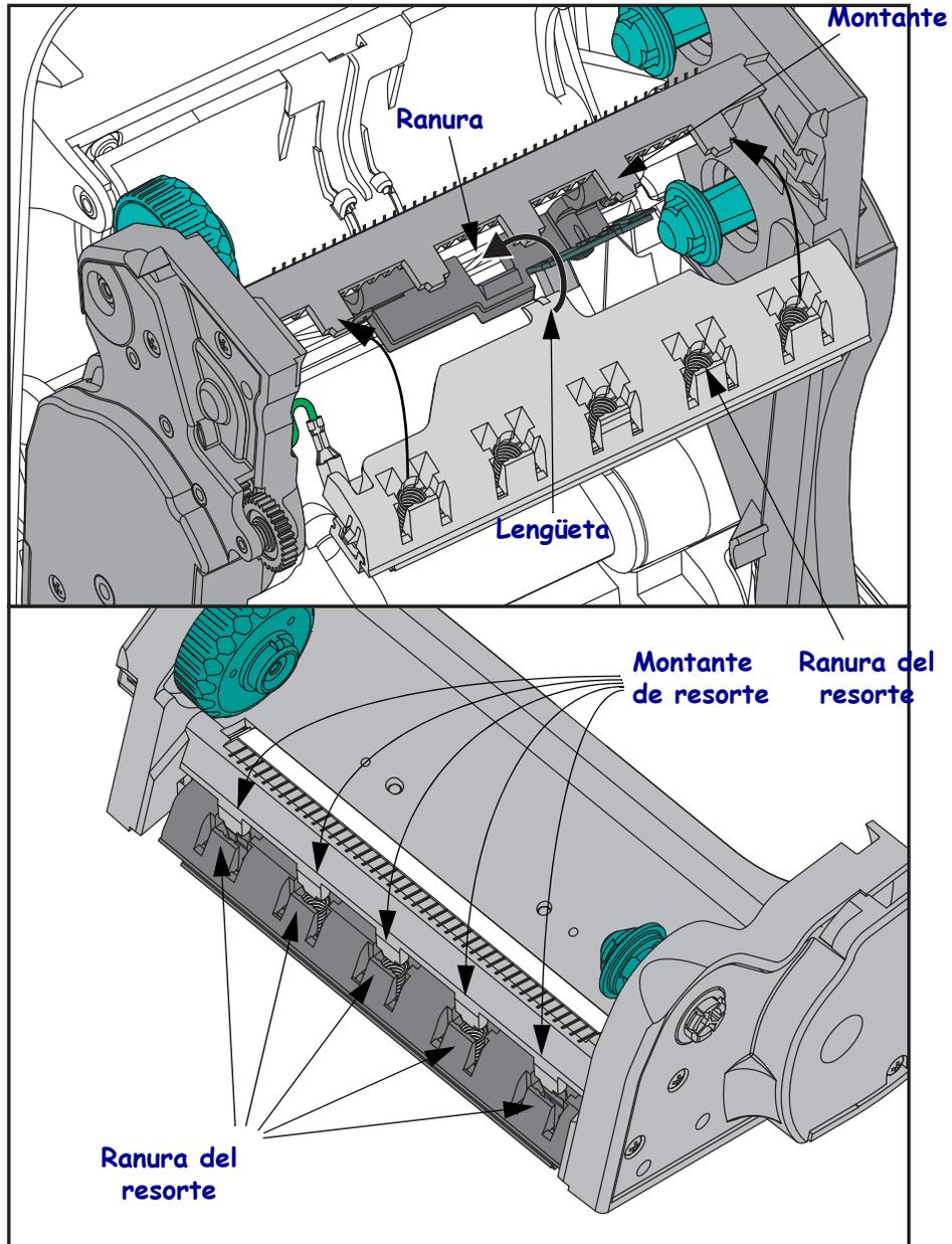
6. Coloque el lado izquierdo de la guía de la cinta en el bastidor de la cinta. Gire el lado derecho de la guía de la cinta en la ranura y presiónelo hasta que quede en posición.
