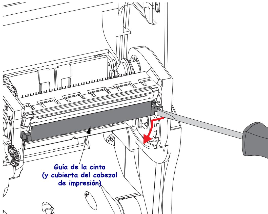
3. Utilice una herramienta con punta roma para presionar la lengüeta de liberación a la derecha y luego a la izquierda del cabezal de impresión. El diámetro de la herramienta puede ser de 2,5 mm a 3,8 mm (0,10 pulg. a 0,15 pulg.).
