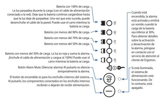
NOTA: La operación frecuente del carro con niveles de carga de la batería inferiores al 30% reducirá significativamente la vida útil de la misma.
