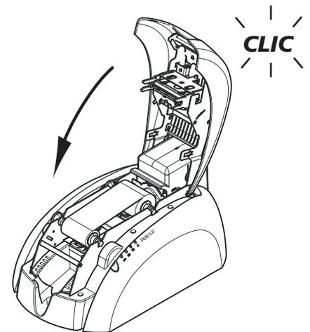
3. Vuelva a colocar la cinta en la impresora, y luego cierre la cubierta.
