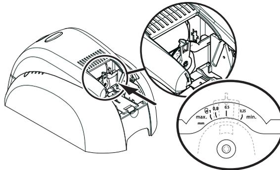
2. Ajuste el grosor de las tarjetas utilizadas moviendo la manecilla de derecha a izquierda para seleccionar el grosor de tarjeta deseado.
