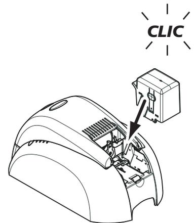
3. Vuelva a colocar el cargador en la impresora. A continuación, presione la parte superior del cargador hasta que encaje con un clic.
