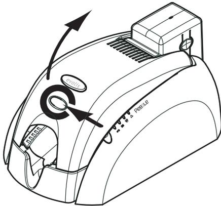
1. Abra la cubierta de la impresora presionando la palanca de apertura y luego girándola.
