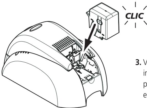
3. Vuelva a colocar el cargador en la impresora. A continuación, presione la parte superior del cargador hasta que encaje con un clic.
