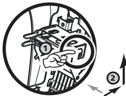
2. Con una mano, empuje la pieza metálica situada en el fondo, bajo la tapa, y con la otra gire los dos ganchos para soltar el cabezal de impresión de su brazo cabezal.
