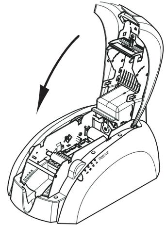
**4.** Cierre la tapa de la impresora. El cabezal de impresión ya está instalado.
