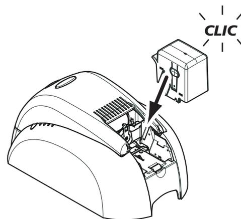
3. Vuelva a colocar el cargador en la impresora. A continuación, presione la parte superior del cargador hasta que encaje con un clic.
