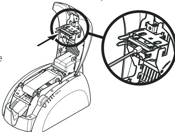
2. Abra la cubierta de la impresora y localice el cabezal de impresión. A continuación, frote el bastoncillo de algodón con delicadeza de derecha a izquierda sobre el cabezal de impresión durante algunos segundos.
