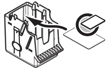
3. Tome una nueva tarjeta de limpieza e insértela en el cargador, tal como se indica.
