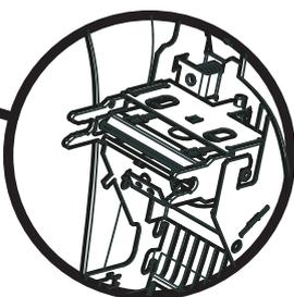
1. Abra la tapa de la impresora y localice el cabezal de impresión.
