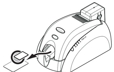
9. La tarjeta de limpieza usada se expulsa a la bandeja de tarjetas rechazadas.
