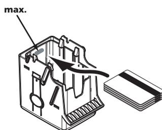
2. Abra hacia abajo el sistema de resorte, tal como se indica, e inserte 100 tarjetas magnéticas como máximo de 0,76 mm.
