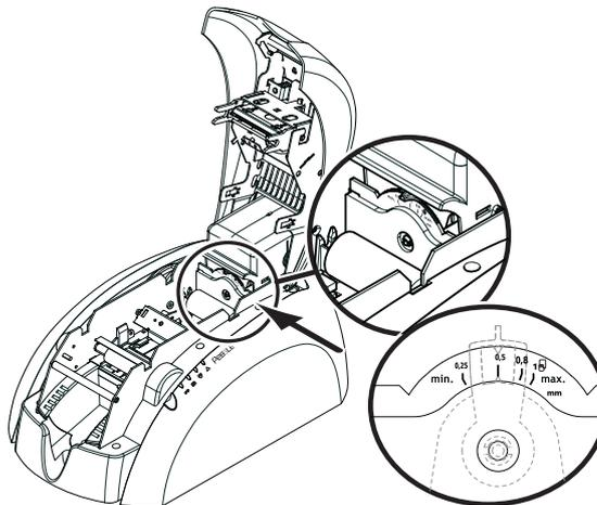
2. Retire la cinta, si está presente en la impresora. A continuación, ajuste el grosor de las tarjetas utilizadas moviendo la manecilla de derecha a izquierda para seleccionar el grosor de tarjeta deseado.
