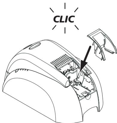
3. Coloque la bandeja de alimentación manual en la impresora, tal como se indica. A continuación, presione la parte superior del cargador hasta que encaje con un clic.
