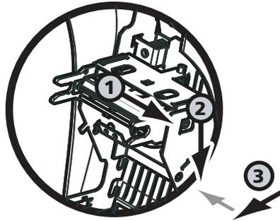
**2.** Inserte el cabezal verticalmente en las dos guías.
