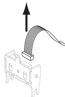
3. Desconecte el/cable(s) situado(s) en la parte trasera del cabezal de impresión.
