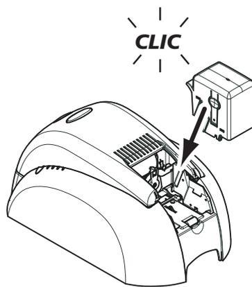
5. Vuelva a colocar el cargador en la impresora. A continuación, presione la parte superior del cargador hasta que encaje con un clic.
