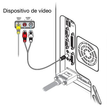
Conecte la salida de audio del dispositivo de vídeo al conector **LINE IN** (🔊) o **MICROPHONE** (🎤) del hardware de audio del PC. Si el dispositivo de vídeo sólo tiene un conector de audio, utilice el conector de audio izquierdo del cable.
