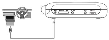
2 Conecte el otro extremo del adaptador en el conector de toma del encendedor de cigarrillos de auto.
