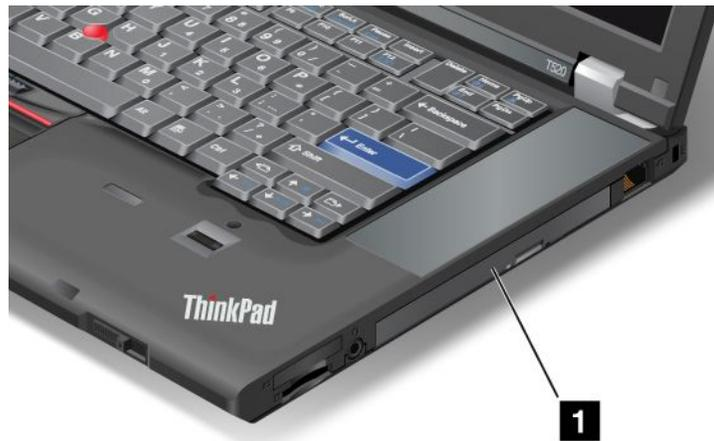
2. Inserte el dispositivo sustituible en la bahía; a continuación, empuje el dispositivo con firmeza hasta que quede fijado en el conector.
