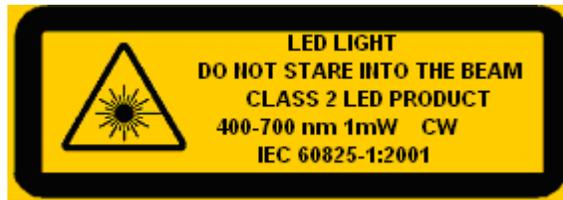
La etiqueta de advertencia de luz LED que se muestra arriba está destinado a informar al usuario la presencia de un producto LED de clase 2. La etiqueta de advertencia de luz LED se encuentra en la parte inferior del cabezal de plástico de la base, como se muestra en el diagrama de abajo. El usuario no debe mirar fijamente a las luces LED clase 2 que están ubicadas en la parte inferior del cabezal de plástico; las luces LED clase 2 son las dos luces blancas y la Luz localizadora en página.
