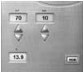
Presentados como se indica al lado, los parámetros de exposición se preprograman en función de las informaciones proporcionadas en los dos bloques funcionales anteriores. No obstante, se pueden modificar los kilovoltios (kV) y los miliamperios (mA).
