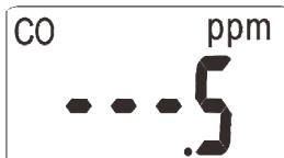
**Nota:** Si el medidor indica '----5' presione el botón de control para pasar al siguiente ajuste.
