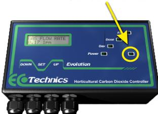
El **Controlador de dióxido de carbono Evolution de Ecotechnics** cuenta con un sensor de luz, tal como se muestra en la imagen de la izquierda. Este sensor de luz se puede ajustar automáticamente para que apague el controlador de CO<sub>2</sub> cuando perciba que es de noche por el hecho de haber menos luz y para que lo encienda cuando vuelva a haber luz por ser de día.
